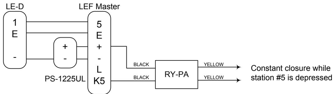
**4) BOTH DOOR RELEASE AND CAMERA CONTROL/LIGHT ACTIVATION**
