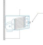
Ajuster la tension des ressorts à l'aide du boulon situé à l'arrière du boîter. Pour obtenir un ajustement idéal, le lit doit rester immobile, peu importe sa position.
